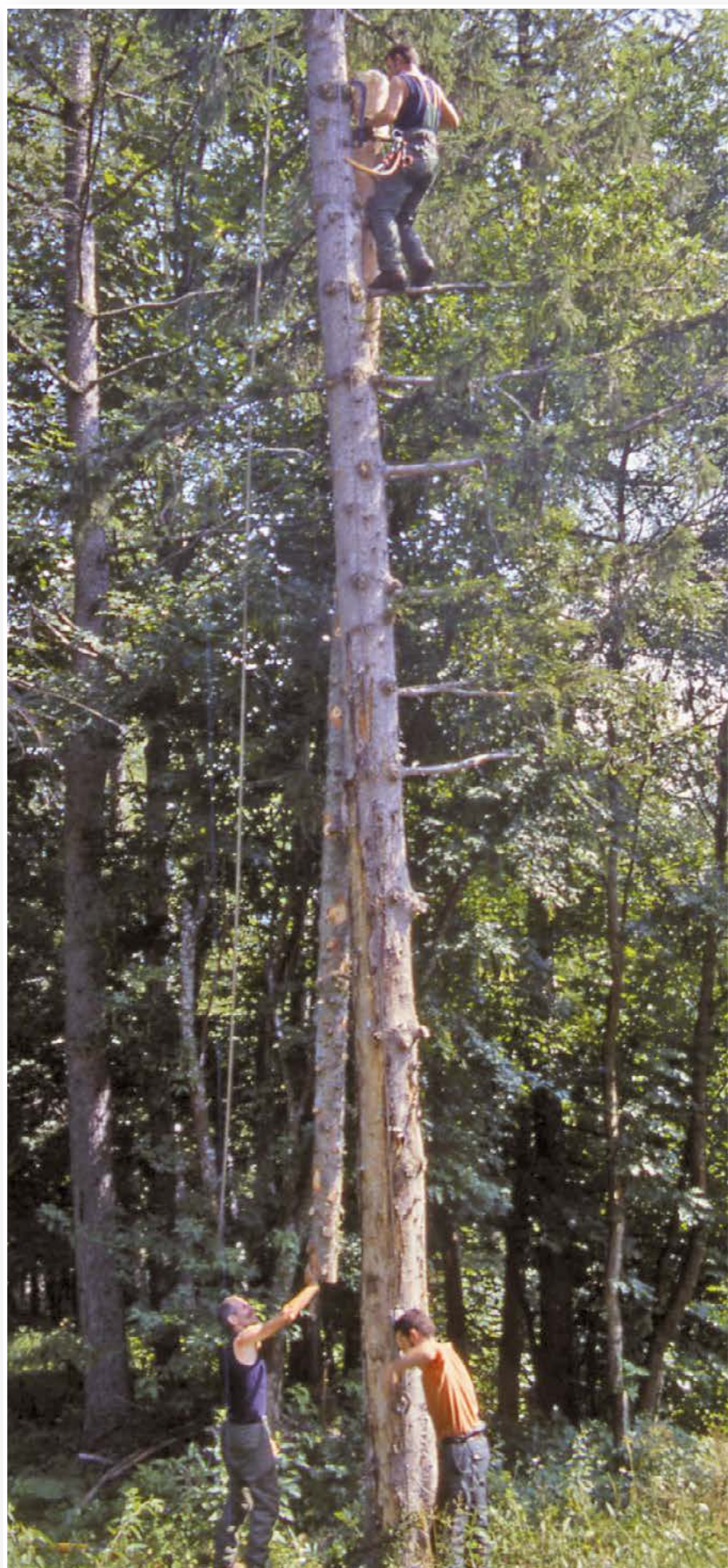
Allestimento di una teleferica per il trasporto dei tronchi.
